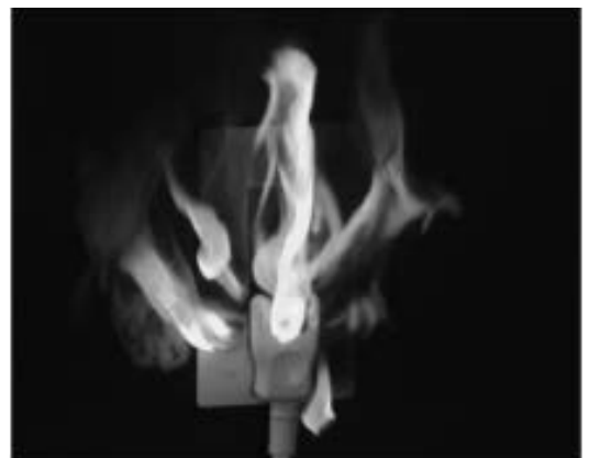
【トラッキング現象※による事故の再現映像】
