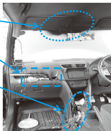
写真2. 車内前方の焼損状況
