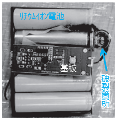
写真、破裂したモバイルバッテリー ※ケースを外した状態
