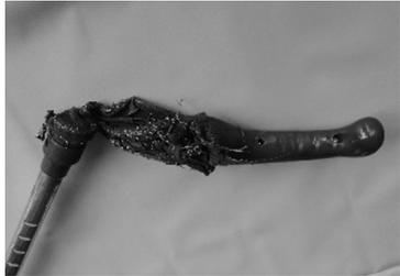
）、内部にあった充電式電池（リチウムイオンバッテリー）2本のうち1本が破裂し、内部の電極が噴出していました（
