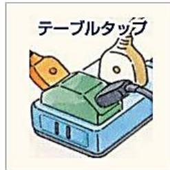
タコ足配線をしていて過熱している…
